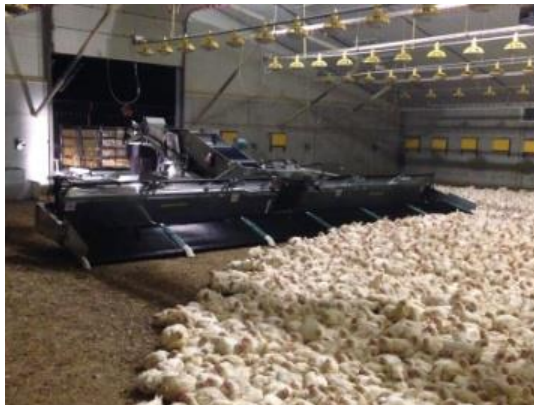
Rysunek 3.3. W przypadku mechanicznego wyłapywania należy sprawdzić stan maszyn Zdjęcie: © GTC Agricultural
