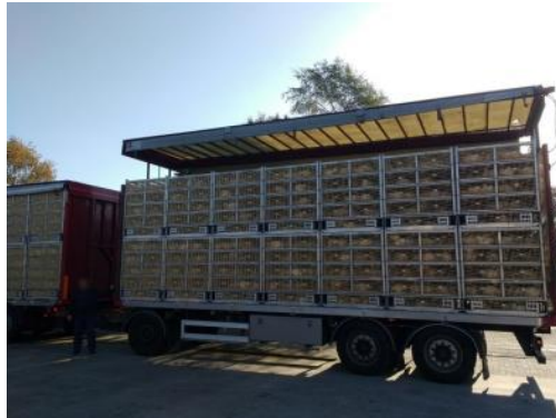
Rysunek 2.4. Pojazd wyposażony w podnoszony dach zapobiegający stresowi cieplnemu u drobiu
